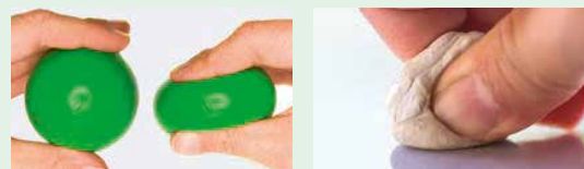
Elastische und plastische Verformung
