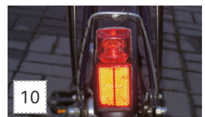
10 Rotes Rücklicht mit Rückstrahler
